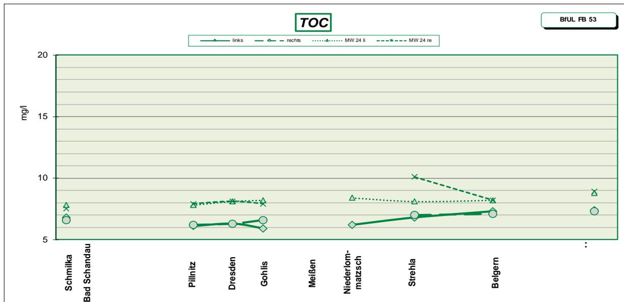
Abb. 4: Mittelwerte des TOC in mg/l aus den Messungen Januar 2025 (links, rechts) und Januar 2024 (MW 24 li, re)
