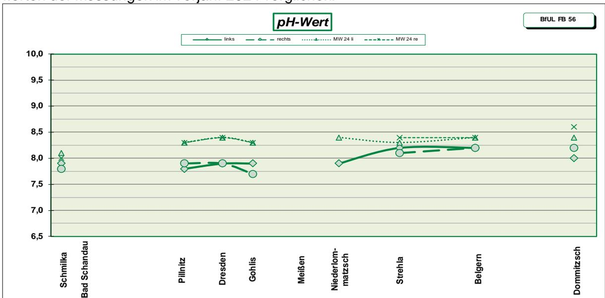
Abb. 3: Mittelwerte der pH-Werte aus den Messungen Januar 2025 (links, rechts) und Januar 2024 (MW 24 li, re)
