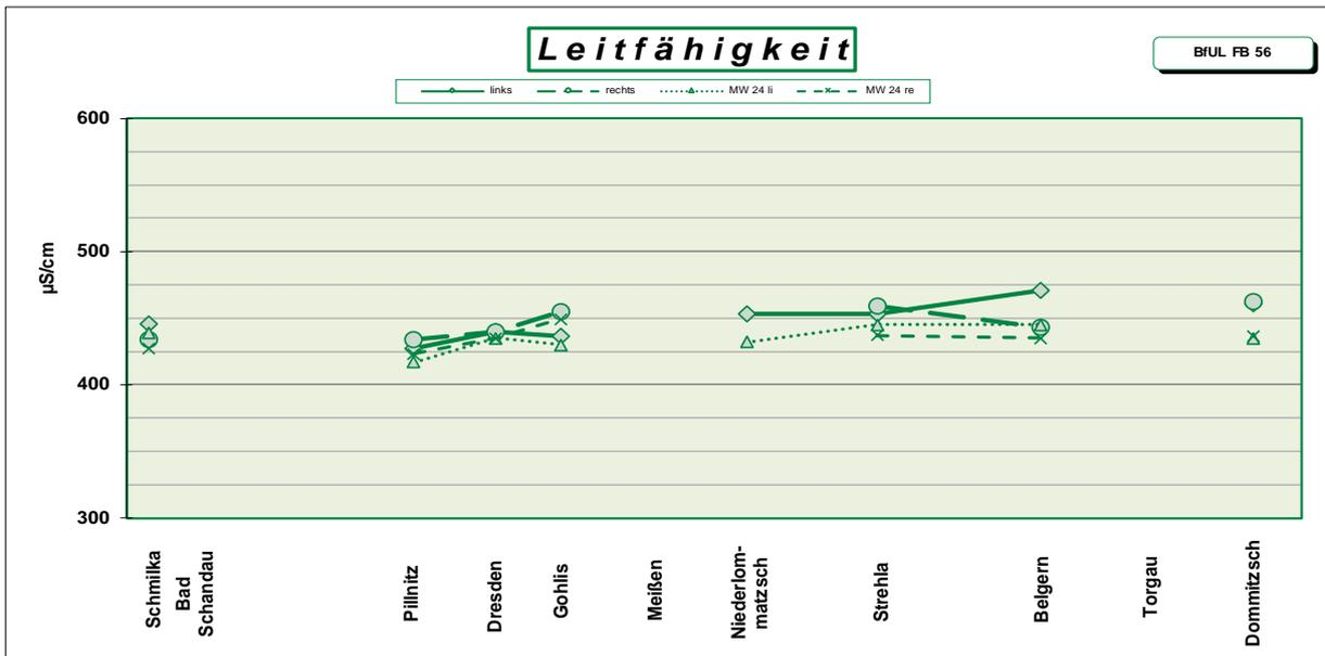
Abb. 2: Mittelwerte der Leitfähigkeit in  $\mu\text{S}/\text{cm}$  aus den Messungen Januar 2025 (links, rechts) und Januar 2024 (MW 24 li, re)
