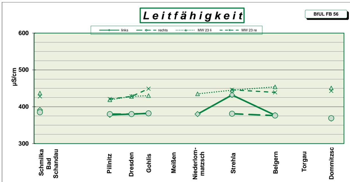
Abb. 2: Mittelwerte der Leitfähigkeit in µS/cm aus den Messungen Juni 2024 (links, rechts) und Juni 2023 (MW 23 li, re)
