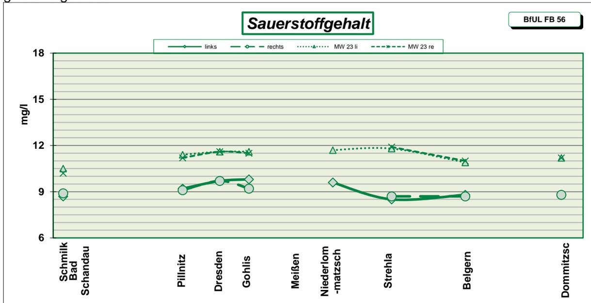
Abb. 1: Mittelwerte des Sauerstoffgehalts in mg/l aus den Messungen Juni 2024 (links, rechts) und Juni 2023 (MW 23 li, re)
